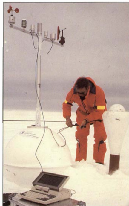
Utplassering av værstasjon på sjøis. Samarbeidsprosjekt NP/NHL/Operatørkommando NORD .
