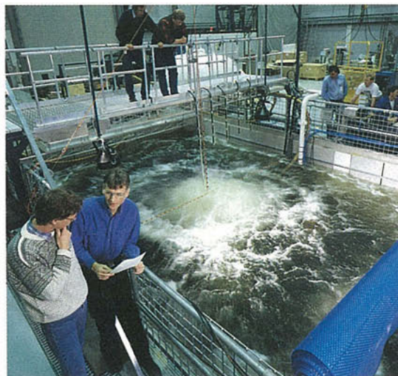
Ved Statoils forskningscenter i Trondheim drives forsøk med gassutslipp under vann i testtanken.
