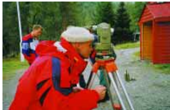
Teodolitten brukes i dag stort sett bare ved tunellarbeider der satellittsignaler ikke kan mottas
