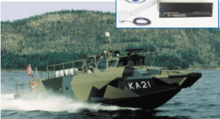
Stridsbåt 90 med Seatex Seapath 200 M. Seapath 200 M bruker både GPS og bevegelsessensorer for å bestemme posisjonen mest mulig nøyaktig. Foto: Kongsberg Seatex.
