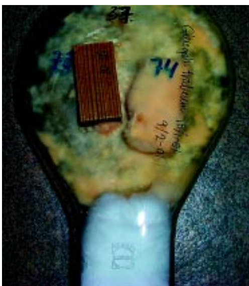
Figur 2. Bildet viser en prøve impregnert med et kitosanbasert middel (til venstre) og ubehandlet kontrollprøve (til høyre) av furu yteved (Testen er utført iht EN 113, her med Gloeophyllum trabeum ). Forsøket er utført for MultiMar AS, Haugesund. Foto: Morten Eikenes.
