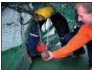
Botnkontakt-sensoren festa på Campelen 1800 botntrål
