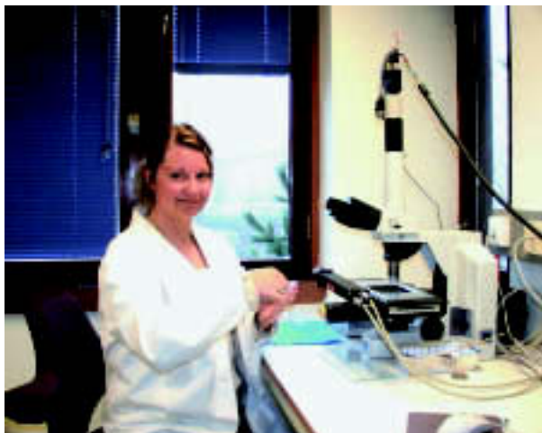
Avdelingsingeniør Katrine Ånestad foretar avlesning av sporfilm på nytt analyseutstyr for radon.
