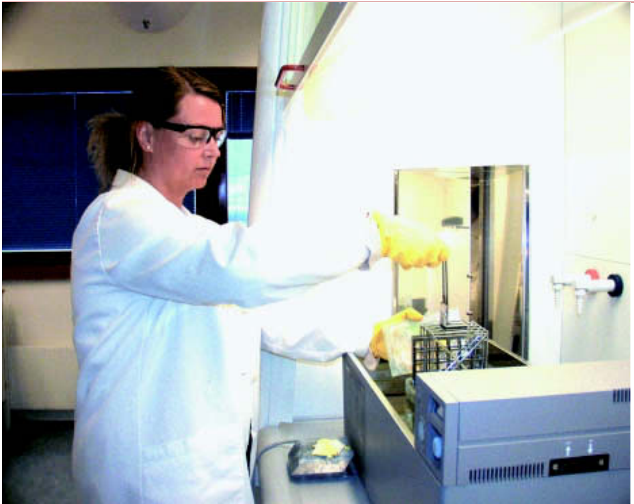
Etsing av sporfilm i lut for å gjøre sporene av radon synlige.
