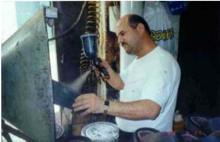
På skofabrikkene brukes sprøytelakkering for å gi skoene den siste finishen Foto: Khaldoun Nijem
