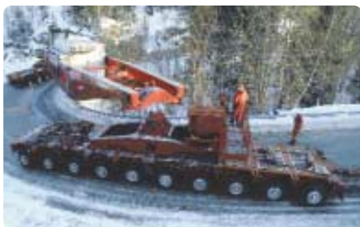
Statnetts spesialtrailer med trafo og en samlet vekt på 400 tonn, opp bakkene mot Liertoppen og Sylling transformatorstasjon. Komplisert kjøring med tung last. Sikkerhet er første bud!
