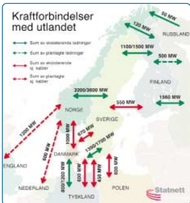
Nye undersjøiske kraftkabler vil ha sitt økonomiske fundament i handelen mellom de markedene de knytter sammen, men kablene vil også fungere som tørrårssikring og bidra til redusert risiko for underskudd på elektrisitet.
