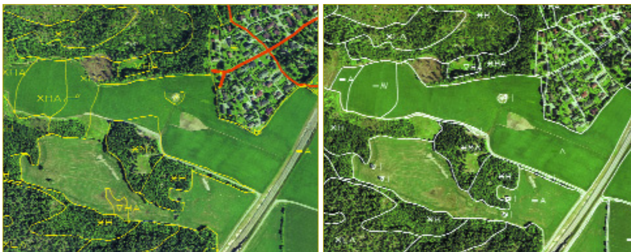
Behovet for oppdateringer i DMK sees godt på de nye digitale ortofotoene (bilde til venstre). De nye markslagsgrensene tegnes direkte inn på ortofotoet, som vist på bildet til høyre, og gir tilnærmet en fasit for arealberegning.
