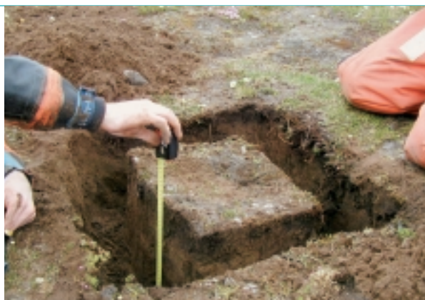
Feltarbeid på Svalbard – gravning av jordprofil for prøvetaking.
