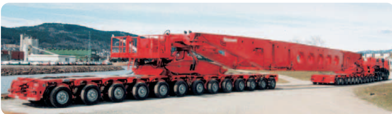
Statnetts kraftige spesialtrailer for tunge transport. Kjøretøyet kan påtreffes fra tid til annen på norske landeveier med transformatorlast på over to hundre tonn. Statnett Transport AS har effektive transportmidler for slike transport både til sjøs og på land.
