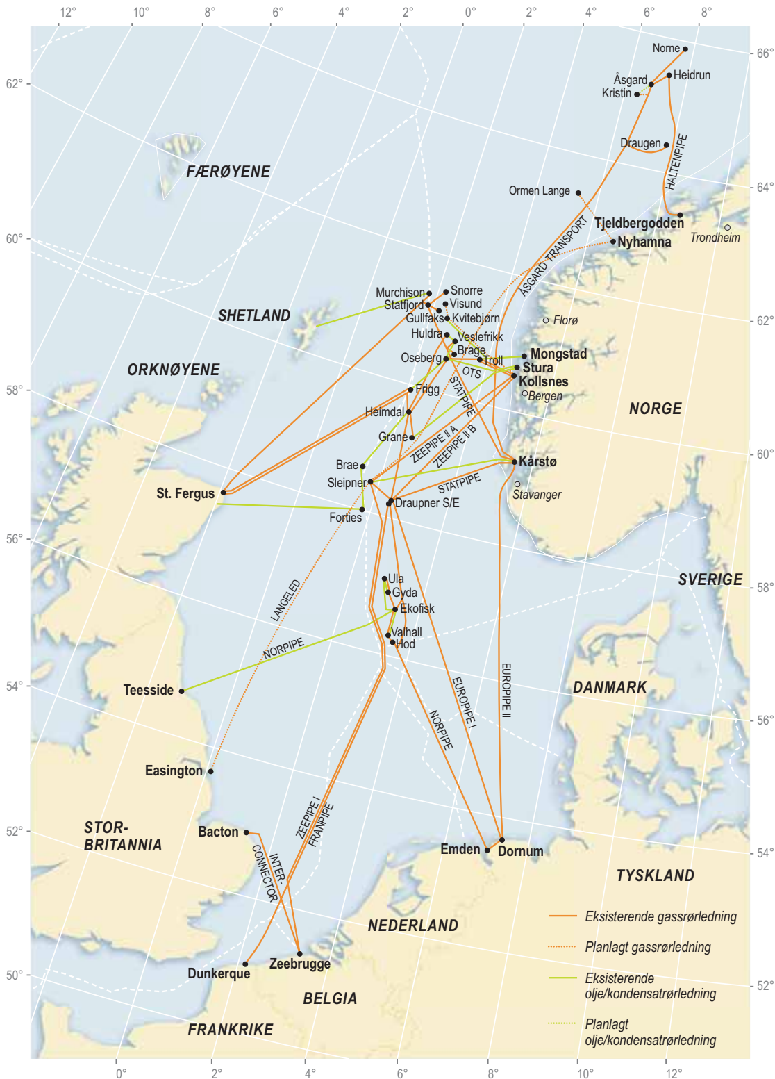
Figur 1.7.1 Transportsystemer for olje og gass med tilknytning til norske felt
