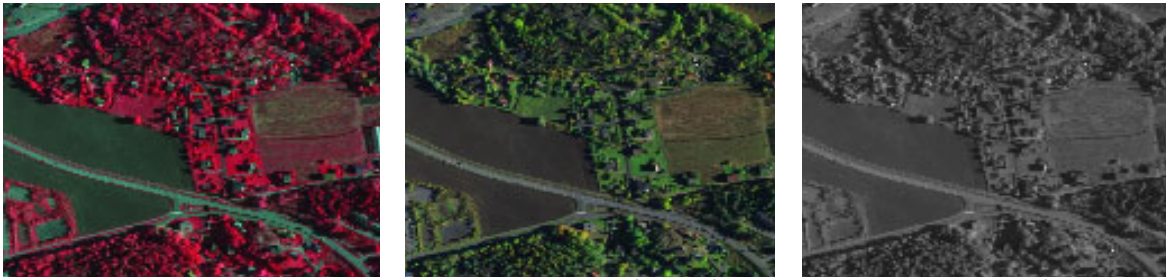
Flybilder tatt med digitale flykameraer gir mulighet til opptak av infrarødt, farge og svart-hvitt i en og samme flyvning. Det gir NIJOS store fordeler med tanke på tolking og analyse av bildene. Foto: Fjellanger Widerøe/TerraTec
