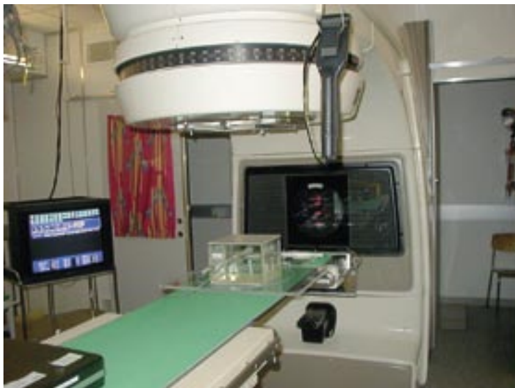
Statens strålevern utfører kalibrering av stråleterapimaskin ved Universitetssykehuset i Tromsø. Det gjøres ved å sammenlikne stråledose angitt på terapimaskinens målere mot doseregistrering med Strålevernets eget, nøyaktige utstyr. (Foto: Statens strålevern.)
