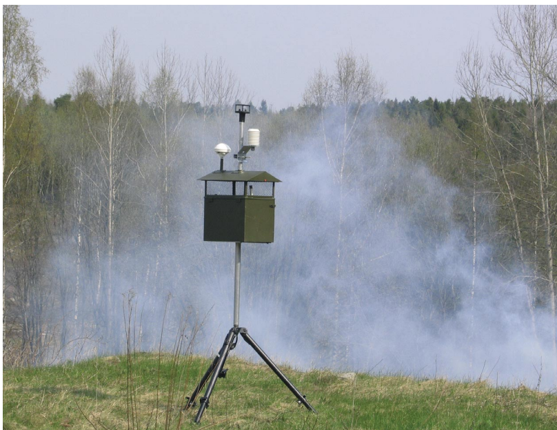
Sensorstasjon under utprøving. CATSS-systemet består av en data-sentral med radiosamband til et nettverk av sensorstasjoner som hver kan detektere og eventuelt identifisere ulike kjemiske stridsmidler, stråling, giftige kjemikalier osv.
