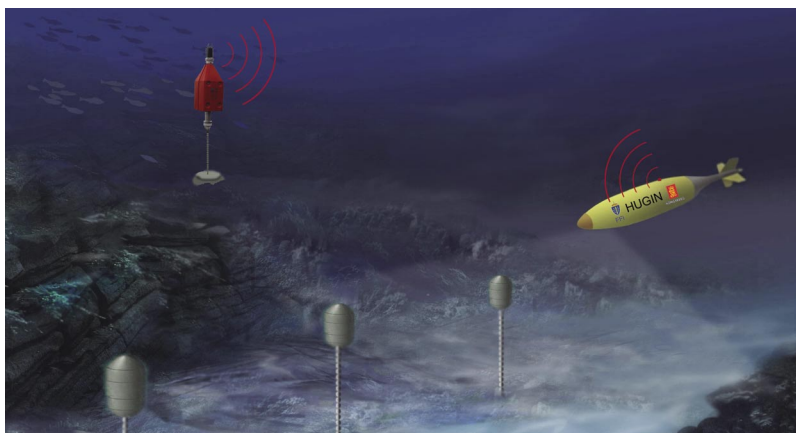
Lydfyr. En undervannstransponder (UTP), som plasseres på havbunnen - AUVen sender ut et pingsignal og UTPen svarer.
