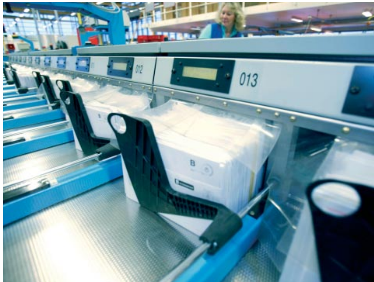
Gjør jobben: En person kan klare å sortere rundt 1400 brev i timen, mens en maskin kan ta unna ca. 27000 brev pr. time. Bildet er hentet fra postterminalen i Stokke i Vestfold.
