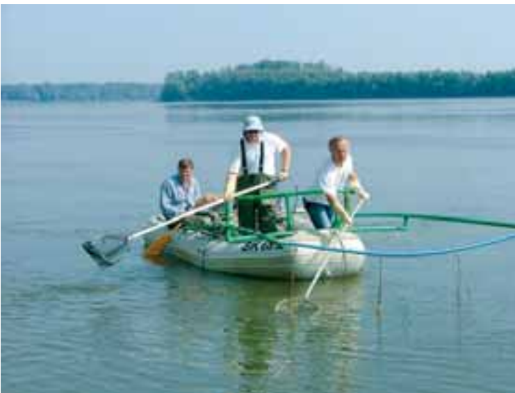
Prøvefiske på Donau med kraftig el-fiskeapparat (11 kW - 4 anoder) Foto: Geir Dahl-Hansen, Akvaplan-niva
