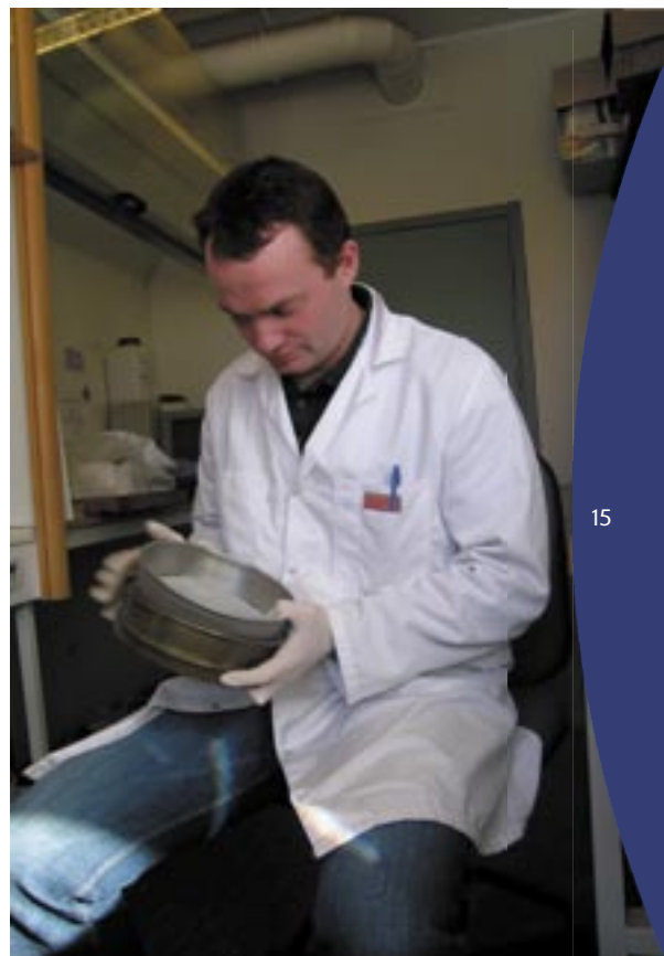
Jordforsk Lab arbeider kontinuerlig med akkreditering av nye metoder. Avdelingsingeniør Olve Frederichsen sikter kalk for opparbeidelse av ny analysemetode. Foto: R. Aspmo
