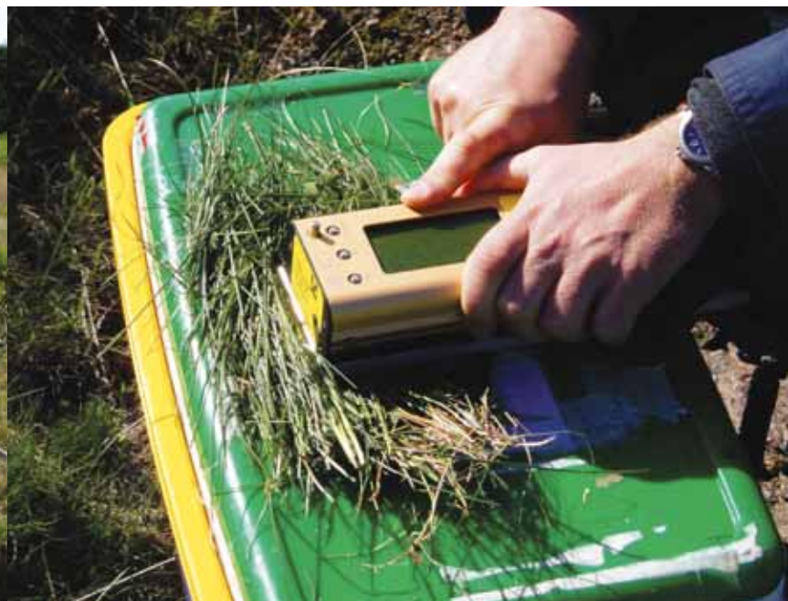
For å måle tungmetallverdier brukes et såkalt XRF-apparat (røntgen fluorosensapparat). Apparatet måler forskjellige tungmetaller i bakken. De vanligste tungmetallene som finnes ved skytebaner er bly, kobber, sink og antimon.
