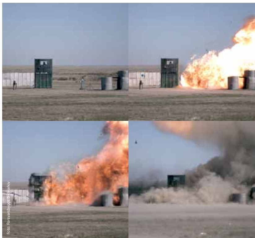
I denne forsøksserien testes en containerbasert observasjonspost for belastningen fra en større FAE-ladning (FAE = fuel, air, explosives).
