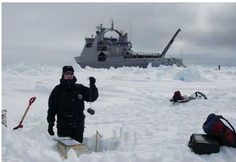
For å kunne foreta satellittbaserte målinger av is-tykkelse må man forstå snøen som ligger som et tungt dekke på isen. Her veier Polarinstituttets forsker Christina A. Pedersen standardiserte mengder snø på en is-stasjon/ In order to use satellite based estimates of ice thickness, one needs to understand the snow that covers the ice. Here NPI's researcher Christina A. Pedersen is weighing standardized volumes of snow on an ice-based station. Foto/Photo: S. Gerland
