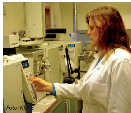
Ved NIFES sitt laboratorium for fremmedstoffer analyseres prøver blant annet for PCB innhold. Bildet viser en såkalt GCMS (gasskromatograf masse spektrometer).
