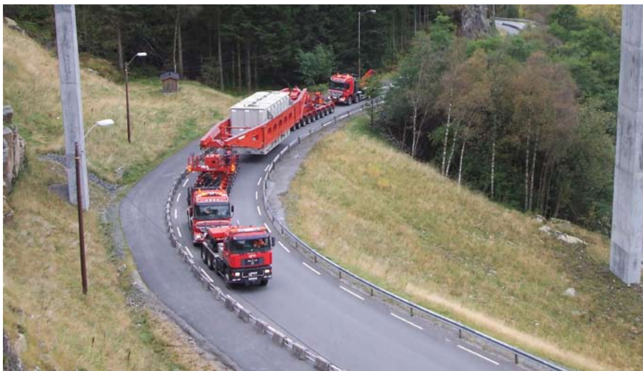
Til NorNed-prosjektet er det produsert åtte transformatorer, fire til hvert land, hver på omlag 250 tonn.
