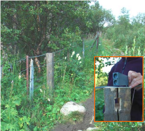
Sensoren er gjemt i gjerdestolpe, for å unngå manipulering av dataene.
