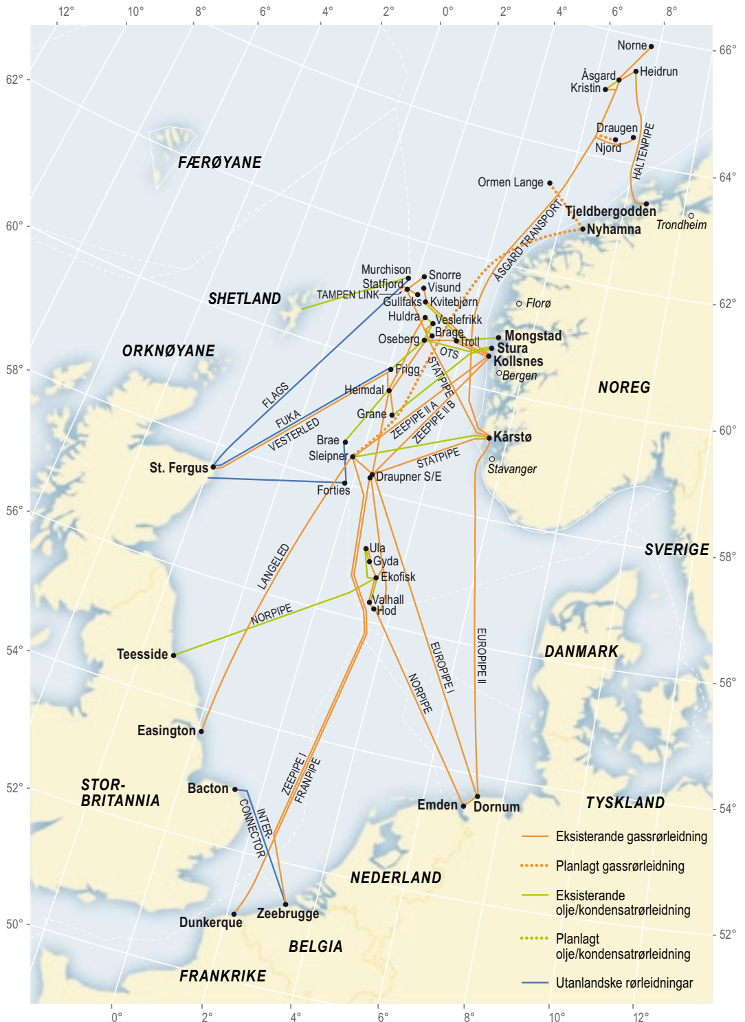
Figur 14.1 Eksisterende og planlagde rørledninger (Kjelde: Oljedirektoratet)
