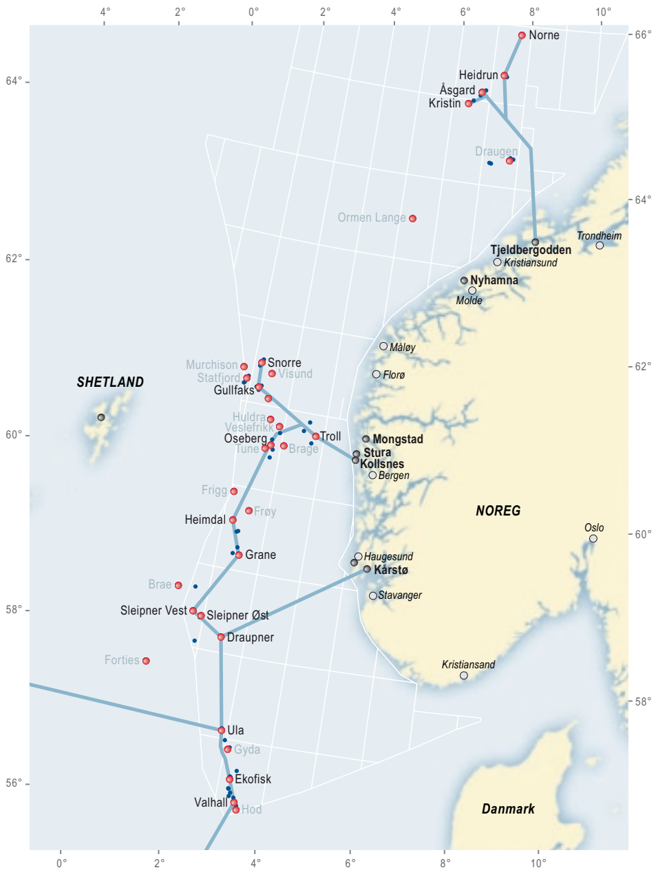
Figur 4.6 Fiberkabelnettet på norsk kontinentalsokkel (Kjelde: Oljedirektoratet)
