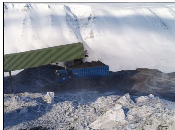
Figur 7.2 Lasting av kullbil ved gruve 7
