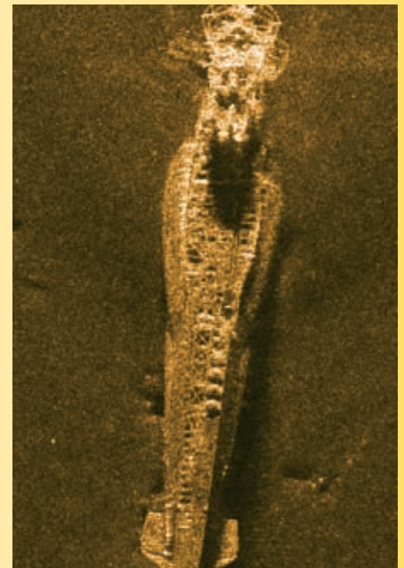
Oppsiktsvekkende oppløsning. Dette er et SAS-bilde av en ubåt fra andre verdenskrig på 196 meters dyp utenfor Horten. Bildet er framstilt med en HISAS 1030 på HUGIN 1000-MR.
