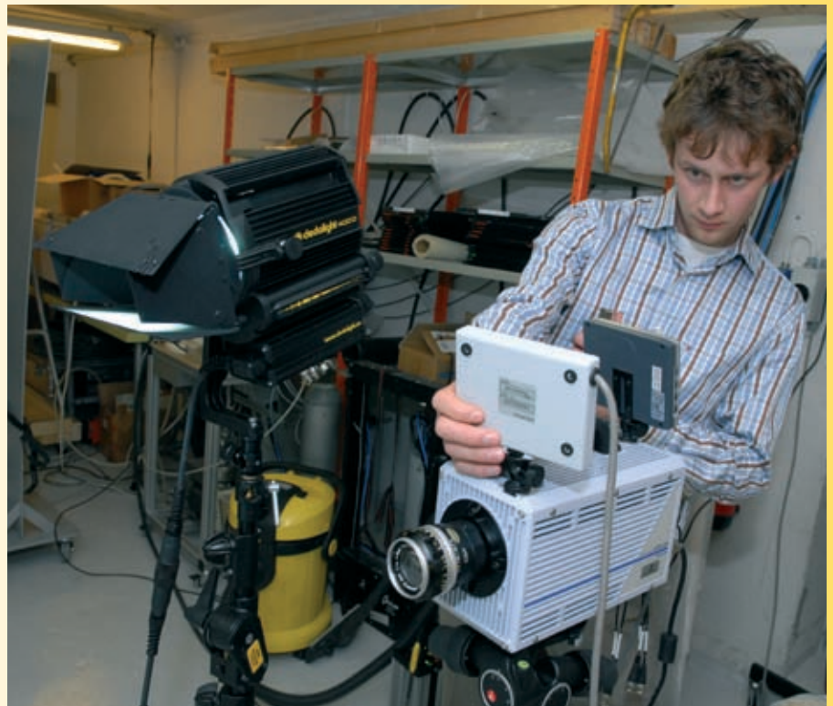
Verktøyet. Høghastighetskameraet på ballistikklaben tek inntil 250.000 bilete i sekundet. – Ein får mykje større forståing for fysikken når ein kan studere det som skjer i detalj, seier Svein Morten Bergsrud.
