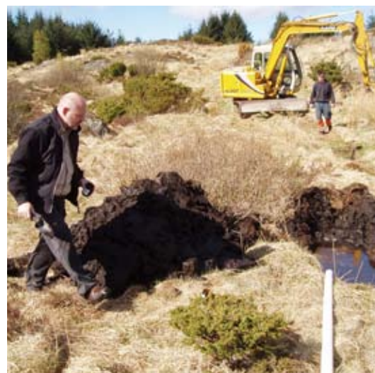
Sjaktning i forbindelse med miljøtekniske grunnundersøkelser. Fjellfort, Sotra. Foto: Harald Bjørnstad
