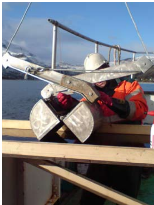
Grabb for prøvetaking av sjøsedimenter, Ramsund. Foto: Vidar Ellefsen
