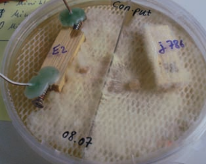
Bilde 1: Kjellersopp ( Coniophora puteana ) vokser på den ubehandlede furuprøven (til høyre), men holder seg unna den PLEOT behandlede prøven (til venstre). Foto: Andreas Treu
