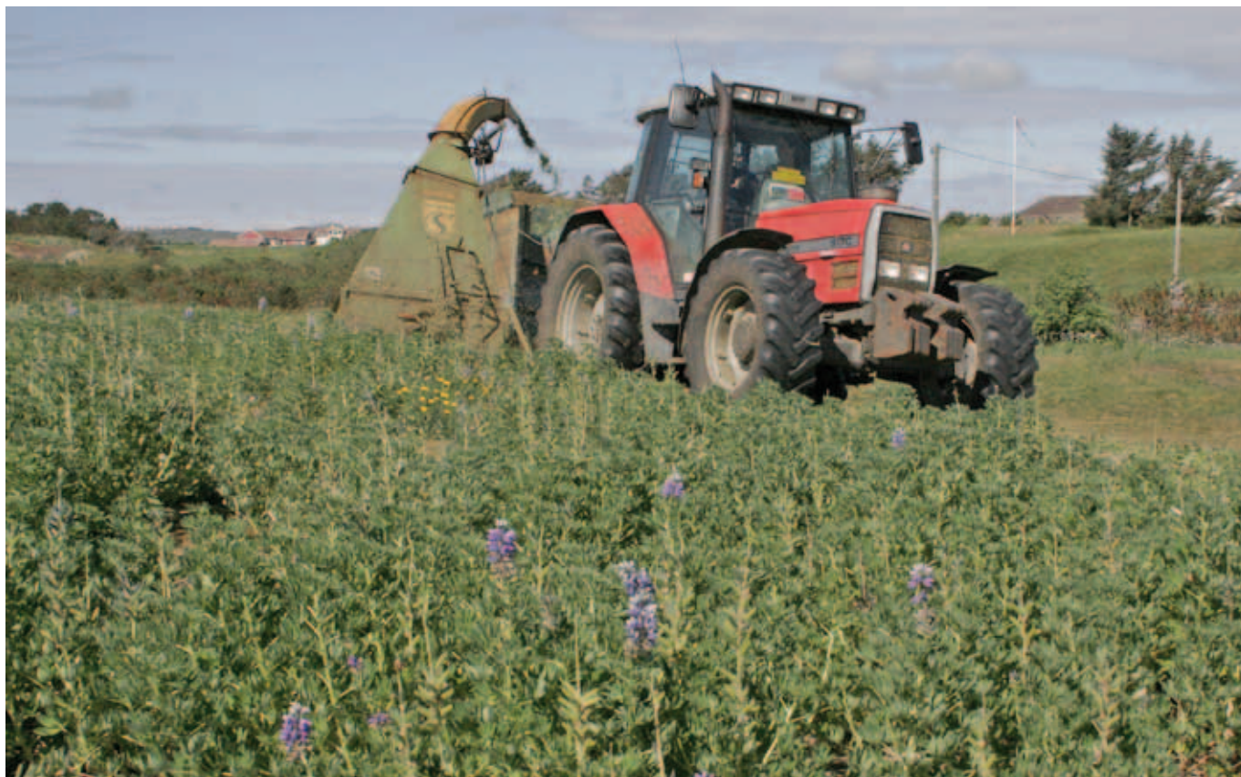
På noen få større areal med flat, jevn overflate benyttes forhøster til slått. Dette er svært arbeidsbesparende. Stor slåttestastighet og all biomasse samles umiddelbart opp i lessevogna.
