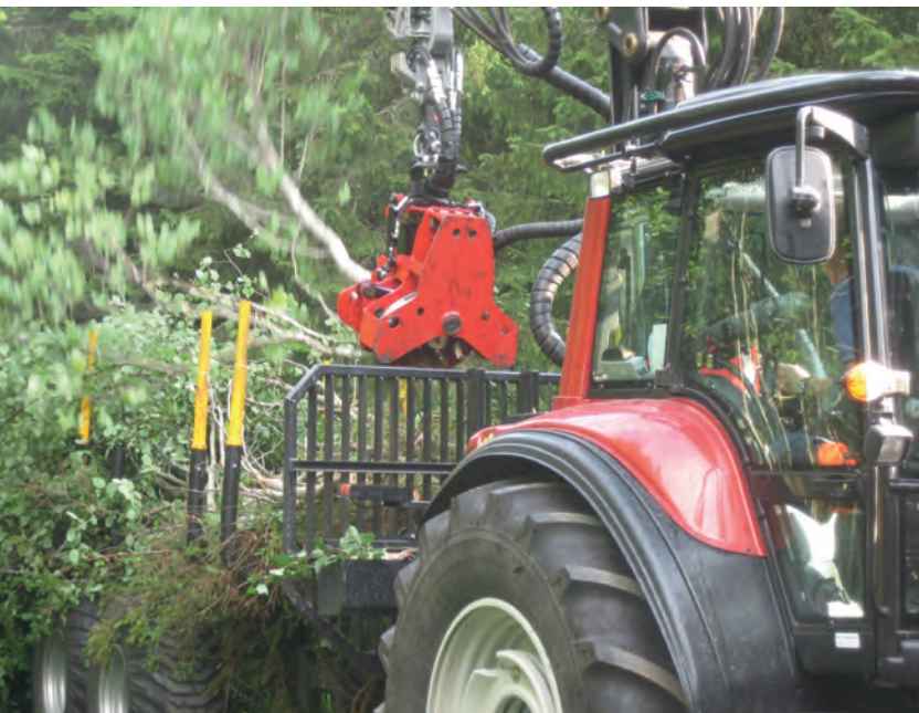
Lett utstyr for smått virke, her et kompakt akkumulerende fellehode på landbrukstraktor. Foto: Helmer Belbo
