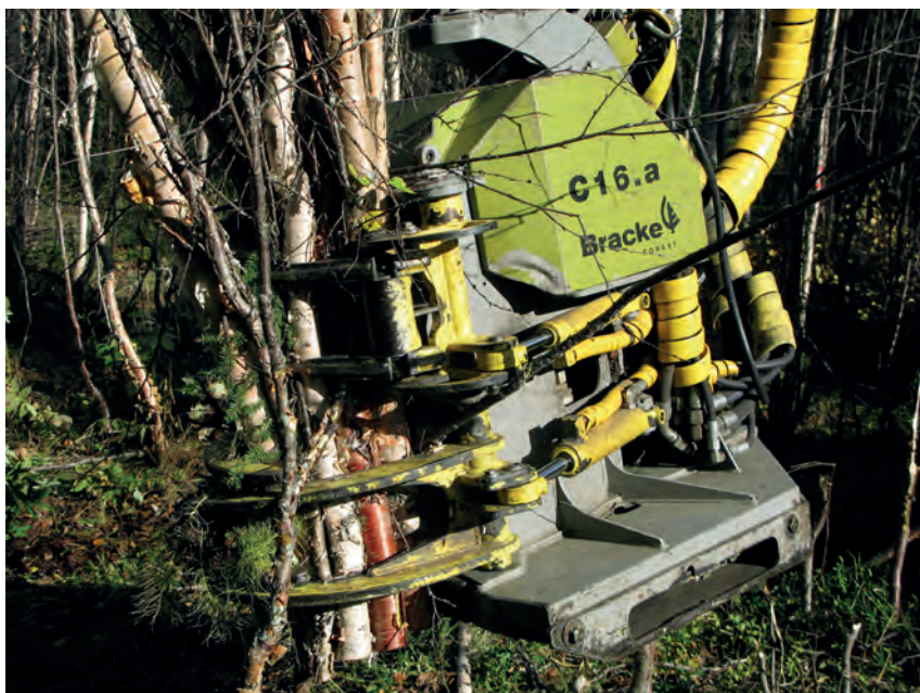
Fellehode med kontinuerlig roterende sagblad for å skille treet fra stubben. Effektivt i drifter med små dimensjoner. Foto: Helmer Belbo
