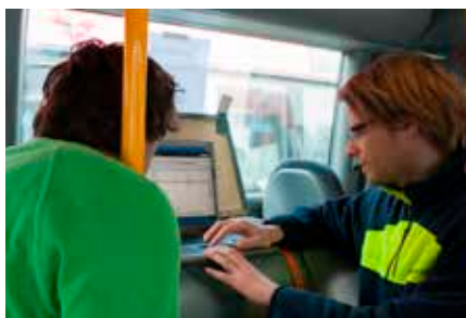
Armin Wisthaler (til høyre) og Tomas Nikovini måler avgasser fra en etanolbuss med PTR-instrumentet. Foto: Claudia Hak, NILU
