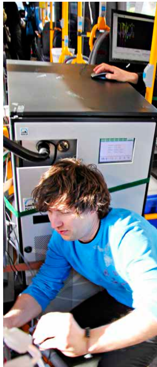
Armin Wisthaler (til høyre) og Tomas Nikovini måler avgasser fra en etanolbuss med PTR-instrumentet. Foto: Claudia Hak, NILU
