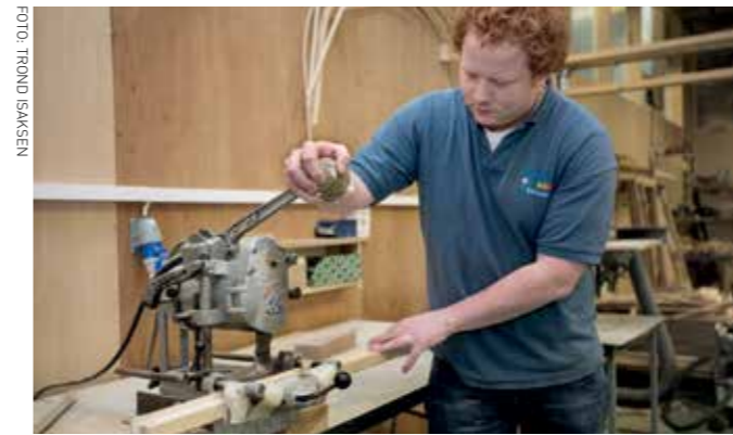
FITCHENSTEMMER. Truls Bratfoss bruker den 50 år gamle Fitchenstemmer'n, kjøpt på tysk nettauksjon og helt uvurderlig for å få på plass hengslene i vinduene.
