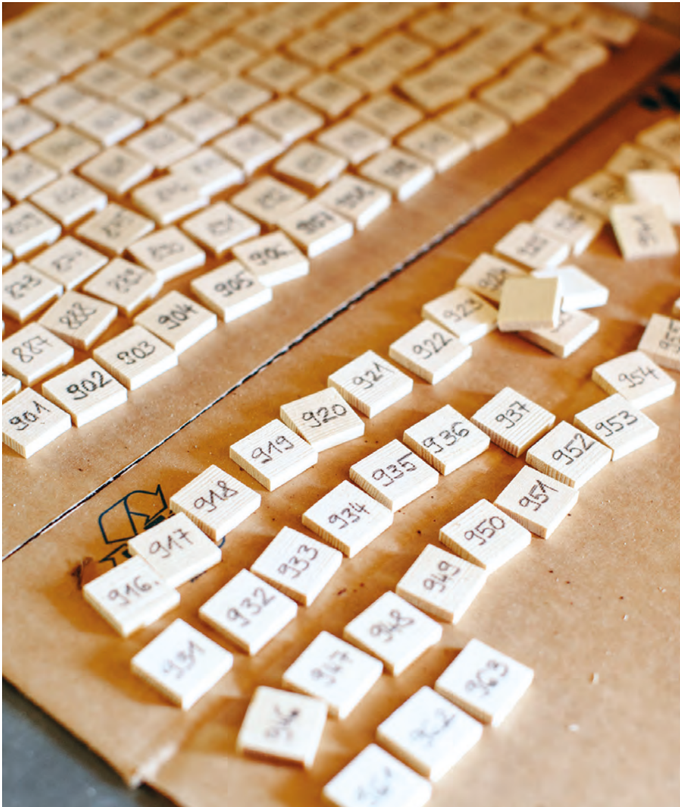
Nøyaktige treprøver laget ved Skog og landskap. Nøyaktighet er veldig viktig i forskning. Disse prøvene er acetylerede, og er nå klare for videre testing. Foto: Thomas Ekström
