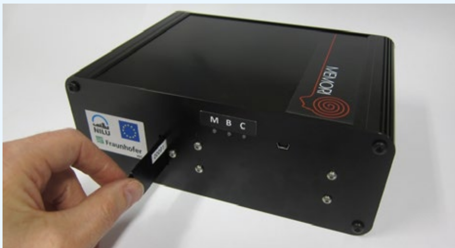
Målingen skjer automatisk når dosimeteret settes inn i det tilhørende måleapparatet. Måling foretas før og etter at dosimeteret settes ut i det aktuelle museet e.l. Foto: Terje Grønøft, NILU
