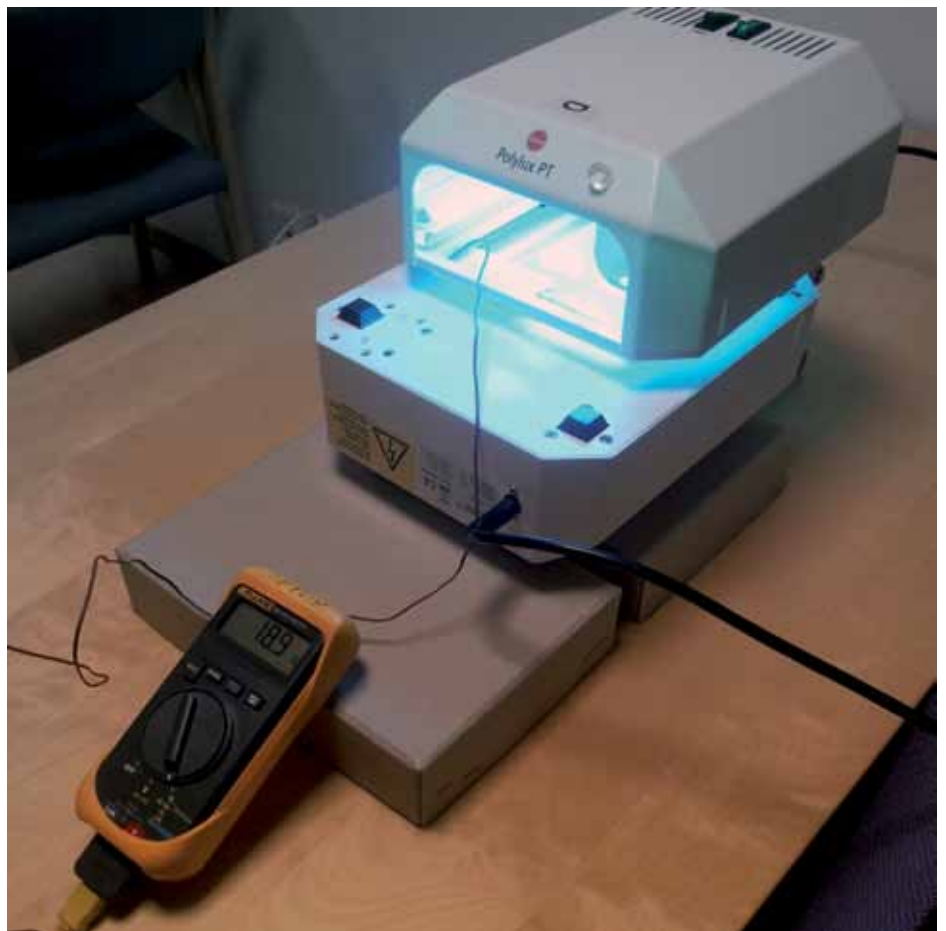
Testing av ulike UV-lamper ved bestråling av fiskeegg. Foto: Thomas B. Aleksandersen, Statens strålevern.
