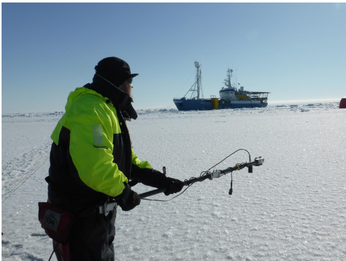
Måling av strålingsflukser over et gjenfrossen råk under N-ICE2015 ekspedisjonen med RV Lance i vår 2015. Foto: S. Gerland/Norsk Polarinstitt
