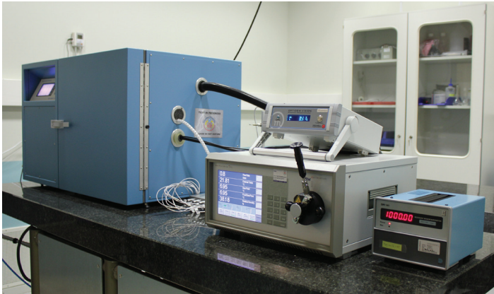
Nytt utstyr for kalibrering av relativ luftfuktighet, lufttemperatur og duggpunkt ble kjøpt inn til hygrometrialaben i 2015.
