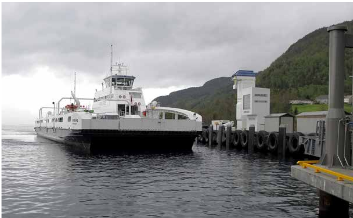
E39 Lavik ferjekai. Batteriferje med ladetårn åpnet 2015. Foto Vegard Bondevik Lie
