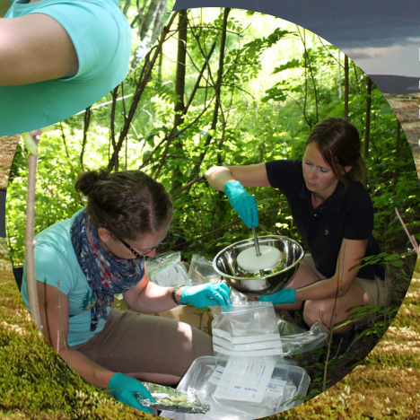
Forskerne setter sammen ufoen ved Bærums Verk. Skiva i midten er filteret som samler opp miljøgiftene fra lufta.
