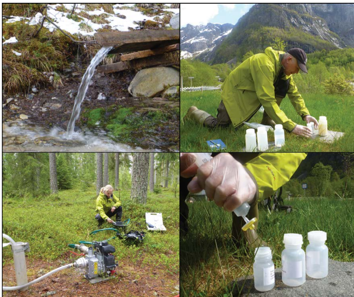
Prøvetaking av grunnvann fra brønner og kilder i felt.
