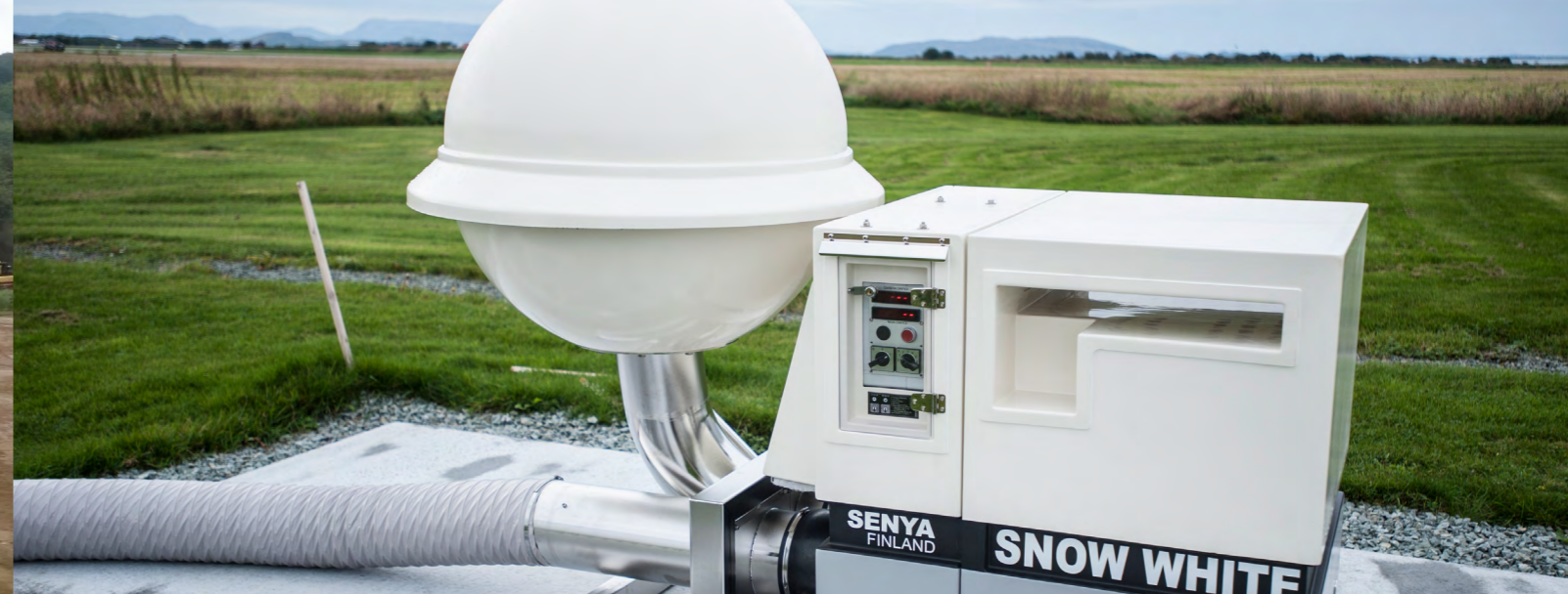
Den nye luftsugeren ved Ørland flystasjon. Foto: Luftforsvaret.
