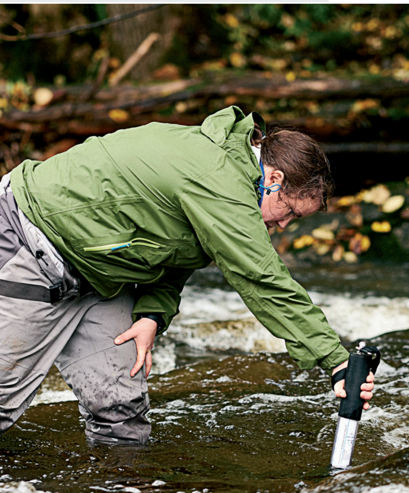
Ingeniør Mari Darrud fra Veterinærinstituttet undersøker klorofyll i alger med en spesiell lykt etter klorbehandling av elva Glitra. Feltforsøket er del av et FOU-prosjekt mellom NIVA, NINA og Veterinærinstituttet og finansiert av Miljødirektoratet. Formålet er å undersøke om tilsetning av klor på nivå med det som er tillatt i drikkevann kan fungere i kampen mot lakseparasitten Gyrodactylus salaris . Foto: Eivind Røhne
