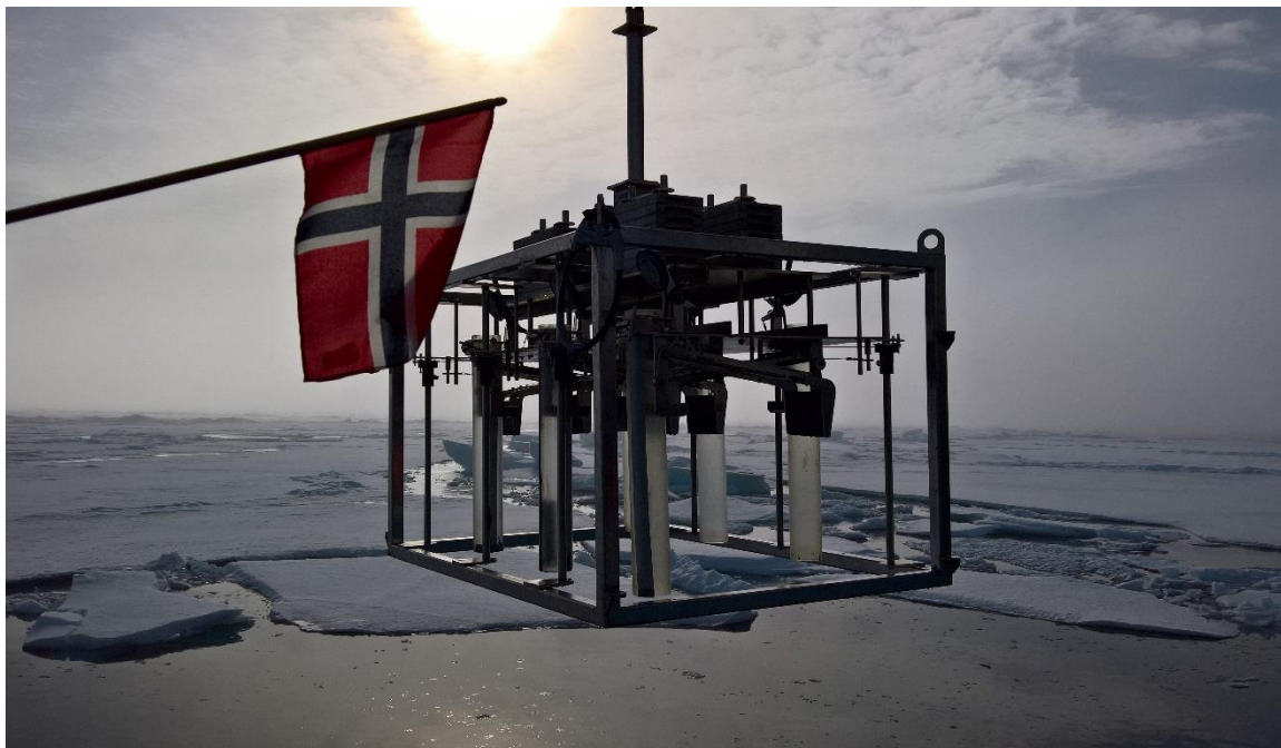
Sedimentprøvetagning med multi-corer fra Lance Foto:Arto Miettinen/Norsk Polarinstittutt.
