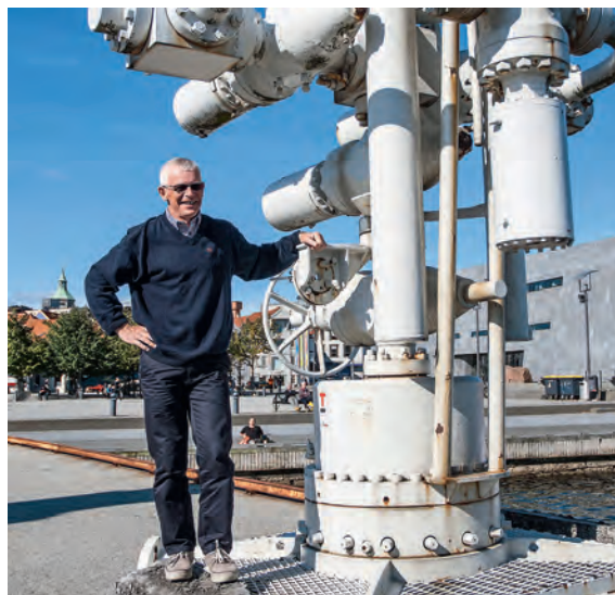
Arnfinn Nergaard ved Norges første undervannsentiltryk. Det sto på Ekofisk på havbunnen under den midlertidige produksjonsplattformen Gulftide. Derfra ble Norges første olje produsert fra fire slike «juletrær» laget i USA. Dykkere måtte ned for å styre ventiltrykene som ble brukt til å kontrollere strømmen av olje og gass fra undergrunnen og opp til plattformen. Foto: Kristin Øye Gjerde
