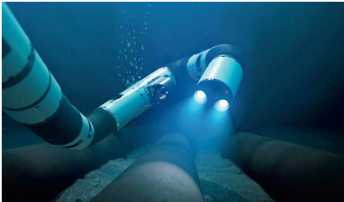
«Undervannsålen» Eelume er en e-rov som kan stasjoneres på havbunnen og være klar til oppdrag 24 timer i døgnet 7 dager i uka uansett værforhold. Den kan til og med styres fra land via 4G-nettet. Foto: Eelume
