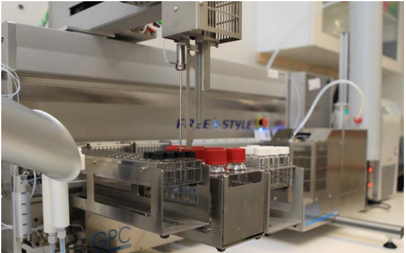
Noen brett med prøveglass er satt inn i roboten, armen har forflyttet seg og er klar til å hente opp innholdet til rensing. Foto: Ingunn Trones, NILU
