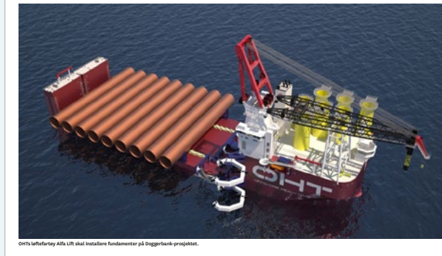
GIEKs leiefartøy Alfa Lift skal installere fundamentet på Doggerbank-prosjektet.
