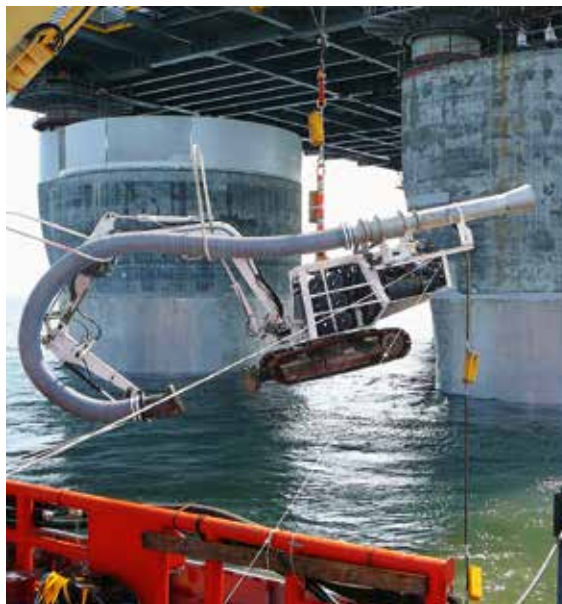
På museum ser den fjernstyrte gravemaskinen uforholdsmessig stor ut, men her - på veg til ein jobb under vatn - ser den faktisk ganske liten ut. Foto: Arild Jenssen.
