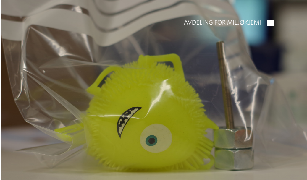
Bildet viser en av lekene fra undersøkelsen i en lufttett ziplock-plastpose. Metallrøret er Tenax TA-luftprøvetakeren. Foto: Ingunn Trones, NILU.
