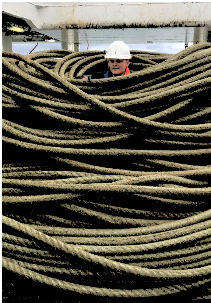
Bildet viser utslitte snurrevadttau, fra rapporten «Slitasje på fiskeredskap».
